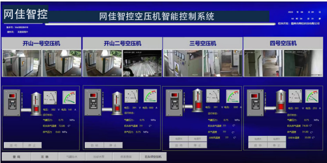
多机组空压集控
